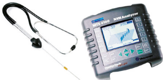
45 pav. Vibracijų ir triukšmo matavimo prietaisai: a) mechaniko stetoskopas, b) triukšmo ir vibracijų analizės prietaisas MTS 4100
