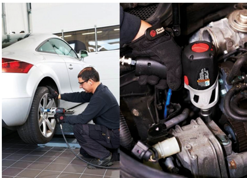
31 pav. Smūginio pneumatinio veržliasukio panaudojimas remontuojant automobilį
