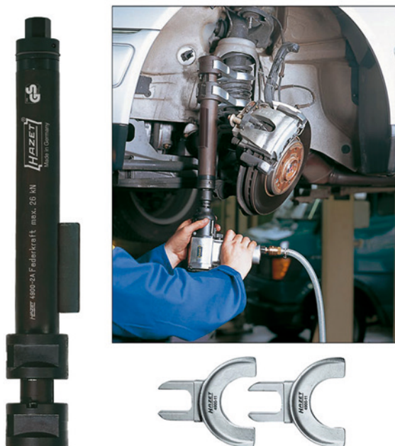
35 pav. „Hazet“ firmos specialus įrankis, skirtas automobilių pakabos spyruoklėms suspausti
