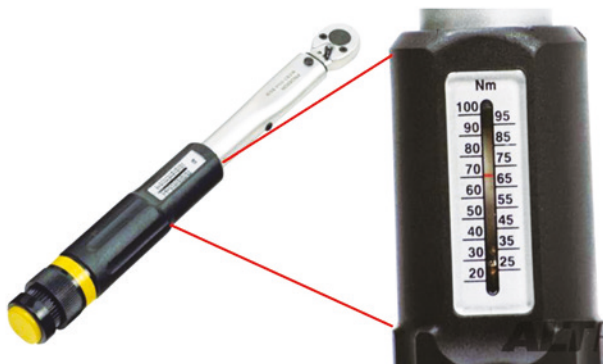
42 pav. Dinamometrinis raktas ir jo skalė
